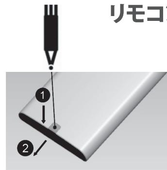
リモコン裏面の下部に付いている穴に、ボールペンなどのペン先を引っかけて下方向に動かしてください。
